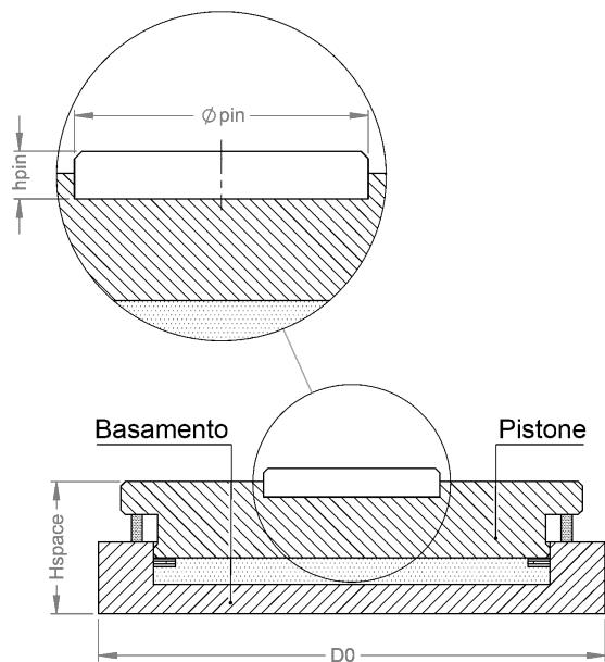
L'appoggio rimane sempre in posizione orizzontale ed eventuali pendenze sia longitudinali sia trasversali dell'intradosso dell'impalcato sono garantite dall'inserimento di lamierini metallici sulla piastra di ancoraggio. In particolare è necessario, di volta in volta, un confronto con l'impresa, il prefabbricatore oppure il costruttore a seconda che si tratti di opere in calcestruzzo, in calcestruzzo armato precompresso o in acciaio.
